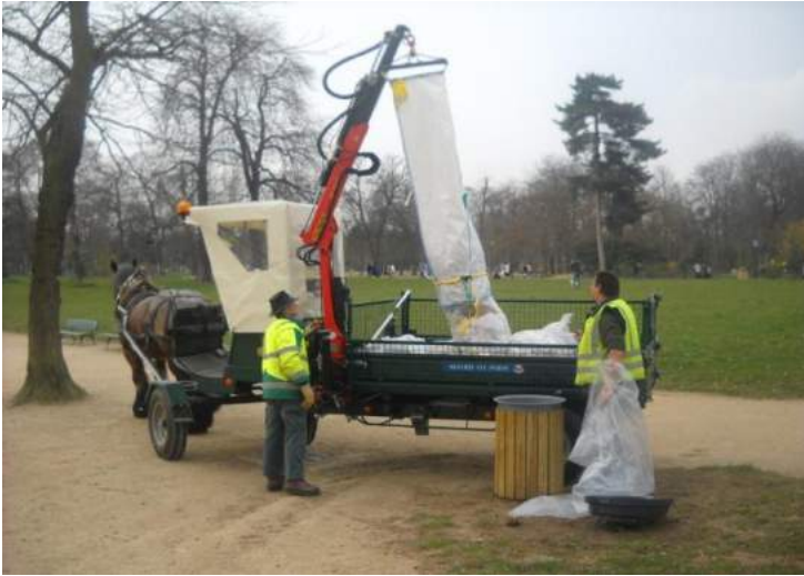
Fig. 1 : Collecte de déchets (la poubelle est enterrée sur 2 mètres, les sacs ont un volume de 300 litres)
